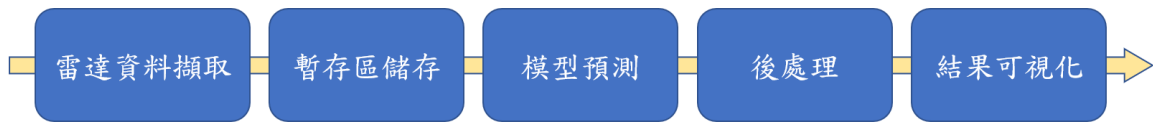
圖 4-18 即時手勢辨識系統流程架構圖：本系統流程包含雷達資料擷取、暫存區儲存、模型預測、後處理與結果可視化等五個階段，資料自 K60168A 雷達即時傳入後，經滑動視窗機制整理成連續輸入，送入訓練完成之模型進行即時推論與顯示
