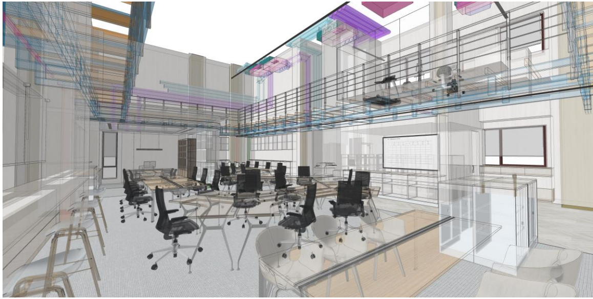
圖 4-12 案例主體空間重塑後 BIM 驗證
