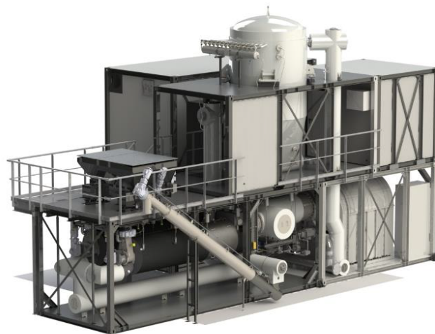
圖 1 -1 PYREG PX1500 L13 xW 7 xH 7.8 m 年運轉固碳 1,800 t CO 2
