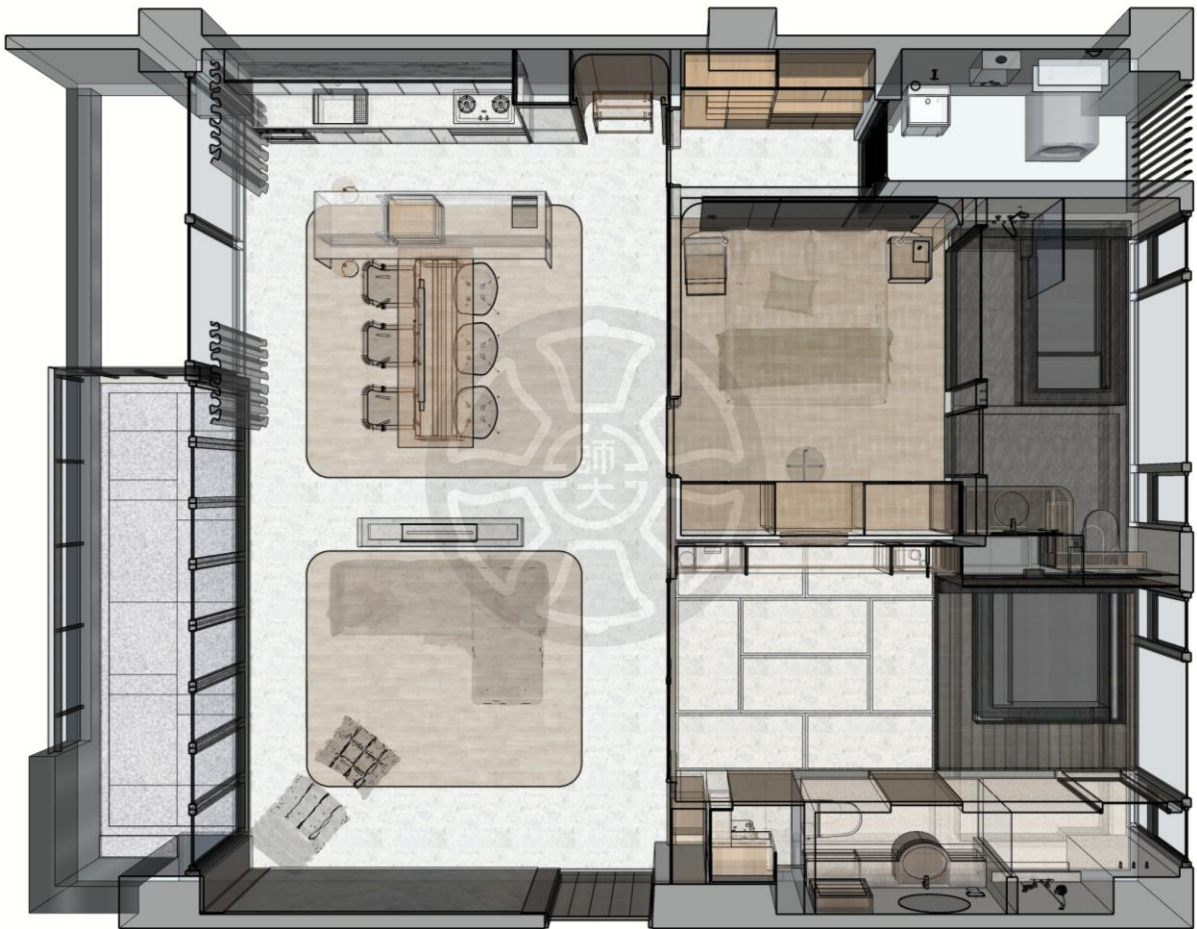
圖 4-28 BIM 複試平面系統立體化後的參變數與材料配置
