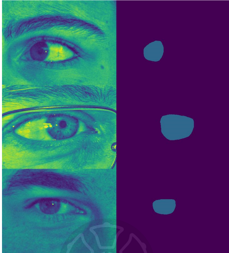
Figure 3.6: 左圖為輸入的眼睛影像，右圖為模型輸出的虹膜分割結果。
