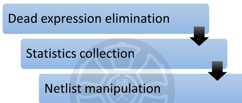
圖 3-9 FIRRTL 優化流程，分別是 Dead expression elimination、Statistics collection 及 Netlist manipulation
