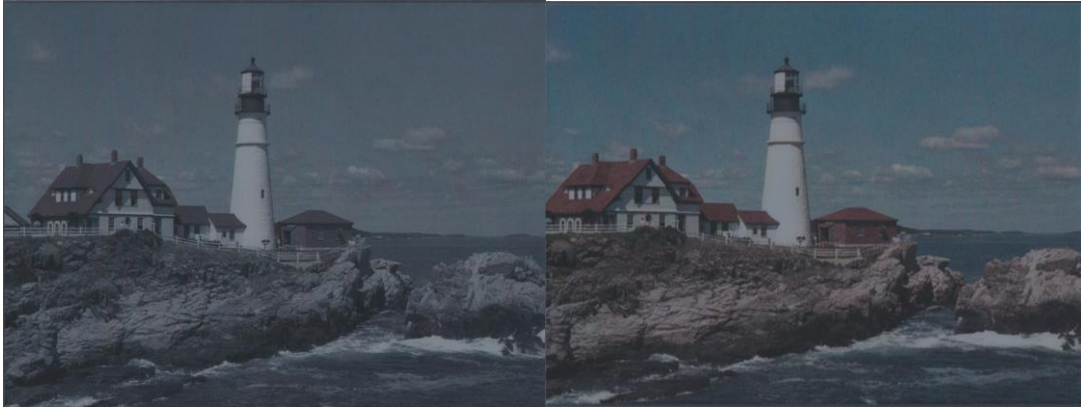
圖 3-5 未進行亮度映射(左)、經過亮度映射後(右)顯示在 PCeP 的畫面
