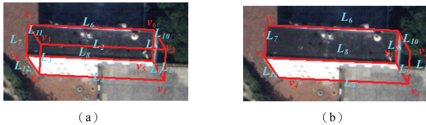
圖 7 線框模型的投影：(a) 所有邊緣線均投影、(b) 隱藏自我遮蔽邊緣線後的投影
