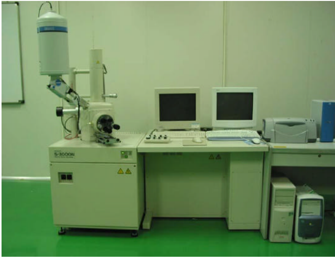
圖 2-5、掃描式電子顯微鏡 (SEM), 由日本 HITACHI 公司製造, 型號為 Model S-3000N。
