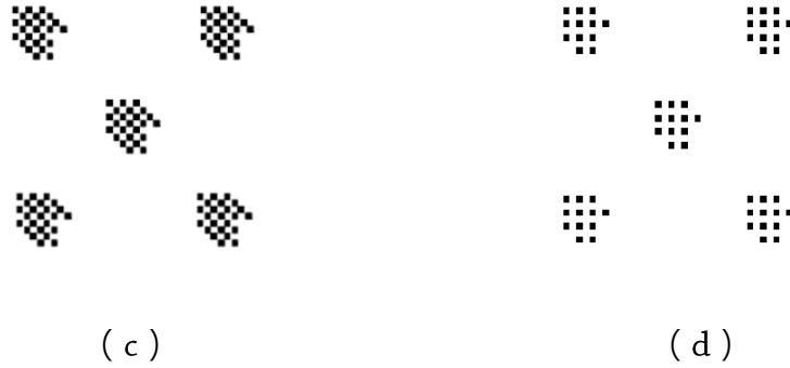
圖 3-3-1 不同著墨比例之調幅網點示意圖 (a) 傳統實心調幅網點 ;(b) 四分之三著墨調幅網點 ;(c) 二分之一著墨調幅網點 ;(d) 四分之一著墨調幅網點 資料來源：研究者繪製。
