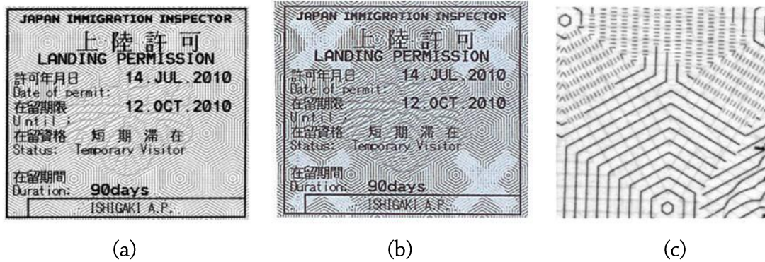
圖 2-2-12 日本入境許可之防偽機制(a)簽證原稿；(b)複印後之影像；(c)浮水印微結構
