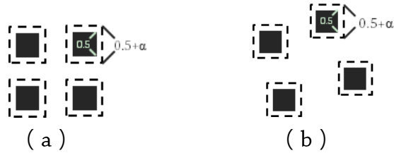
圖 4-1-6 網點面積百分比 1%之改良式混合網點示意圖 ( a ) 四分之一著墨 AM 網點 ; ( b ) FM 網點
