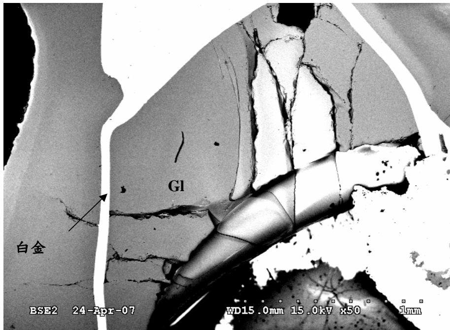
圖 3-3、1275°C 下之反射式電子影像圖，圖中全為玻璃(Gl)相。
