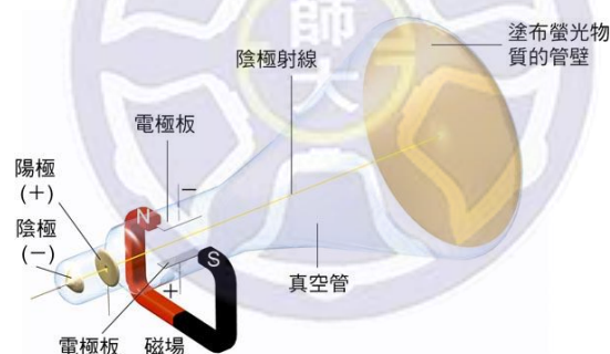
▲圖 4 湯姆森測定荷質比的裝置示意圖：陰極射線在同時控制磁場和電場的交互作用下，仍可能保持原來的軌跡。
