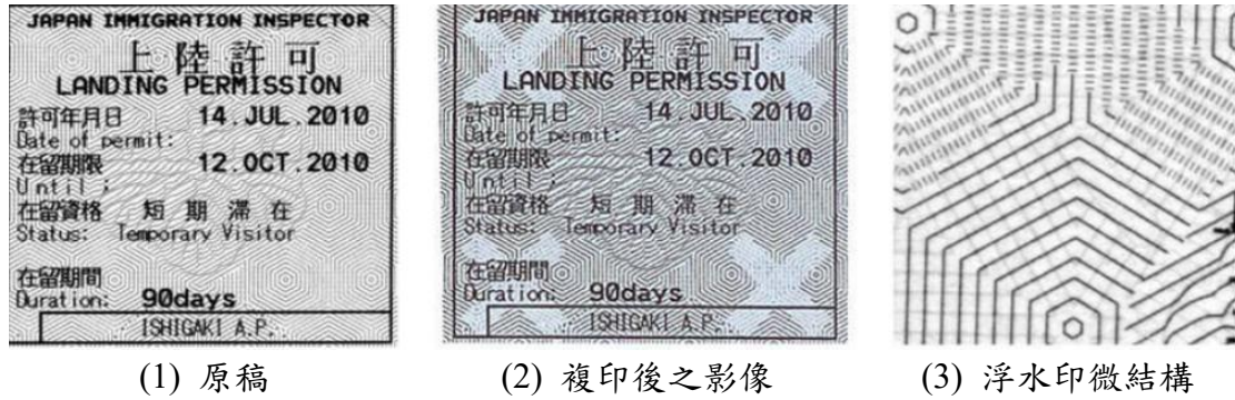
圖 2-36 日本印刷局印製之採用不同微結構線段製作浮水印 資料來源：次媒體實驗室掃描取像
