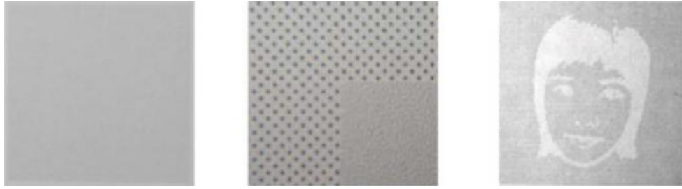
1) 一定距離觀測之浮水印原稿 2) 混合網點浮水印微結構 3) 複印後顯現浮水印示意圖
