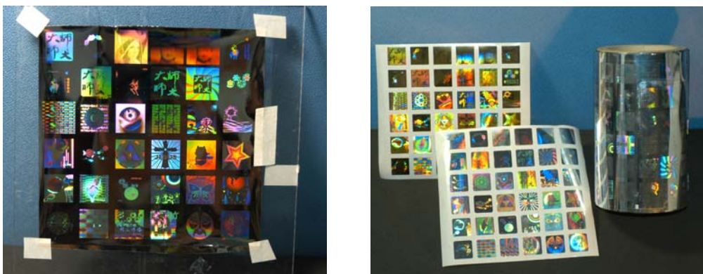
圖 2-8 (a)全像印版 (工作版) (b)經滾壓後的全像片
