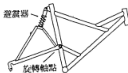
圖 4-6 高轉點後避震車架結構圖
