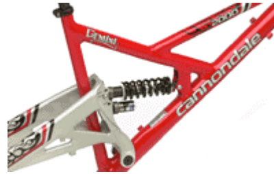
圖 4-13 單一轉軸後避震系統
