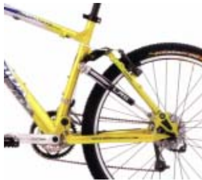
圖 4-16 低槓桿比避震系統
