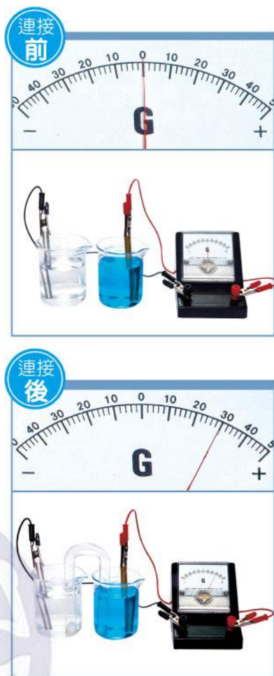
圖四 U型管連接兩個燒杯形成通路，使得檢流計發生偏轉
