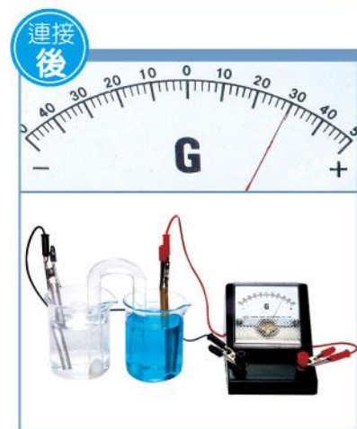
圖四 U型管連接兩個燒杯形成通路，使得檢流計發生偏轉
