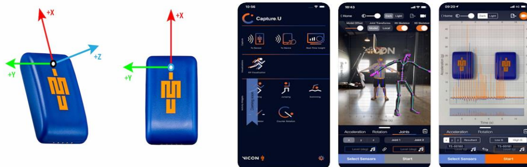
圖 3-1 VICON Blue Trident IMU 與 CAPTURE.U 軟體
