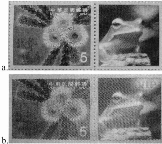
圖一 MCWT 加密後及解密後所觀察到的印刷影像 (a) 加密後的實際輸出影像 (b) 透過 75Lpi 光柵觀看的影像，在影像右上角可看出隱藏的 VIP 字樣
