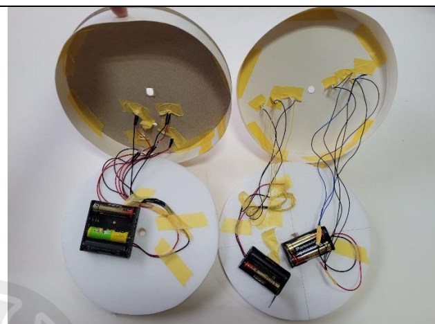
圖 4-27 閃爍型與持續光型 LED 草模的內部電路結構
