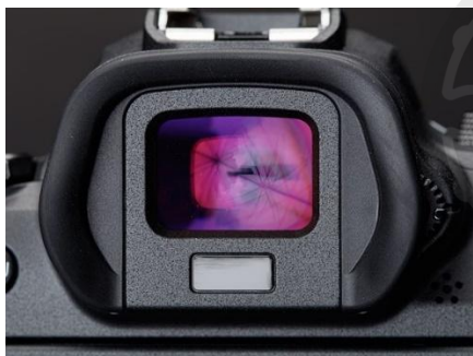
圖 2-11 佳能的數位相機 R6 上的取景器
