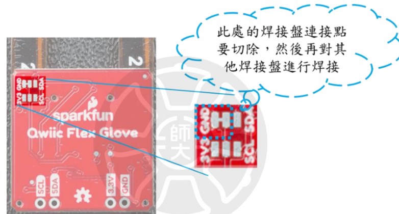
圖 25、Sparkfun 的 Qwiic Flex Glove Controller 地址修改處，這六個焊接盤的部分為修改感測器地址的地方。
