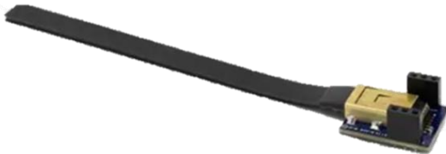
圖 9、此彎曲感測器為 Bend Lab 的 Digital Flex Sensor，感測器內含有數位處理器架構，感測器可以主動提供訊號，且感測器質地柔軟、在感測方面較為精準，但成本較高且已停產。
