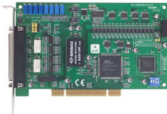
圖 5-4 研華科技公司 PCI-1720U 資料擷取卡
