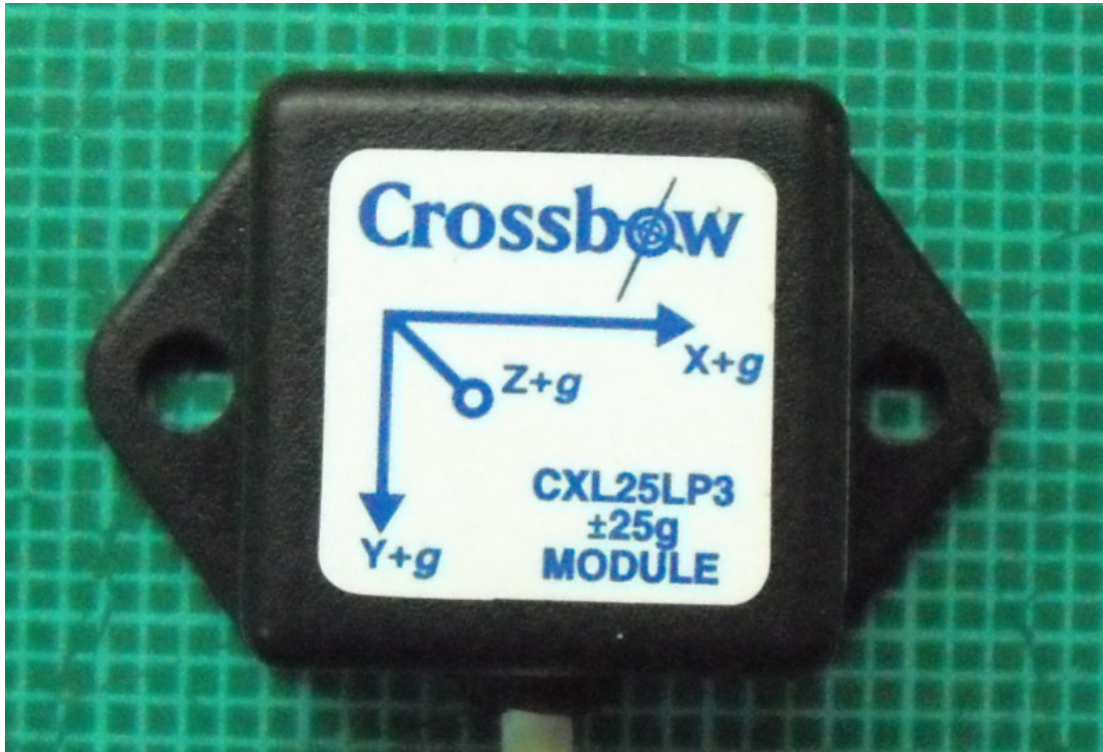
圖 10 CROSSBOW 雙軸加速規
