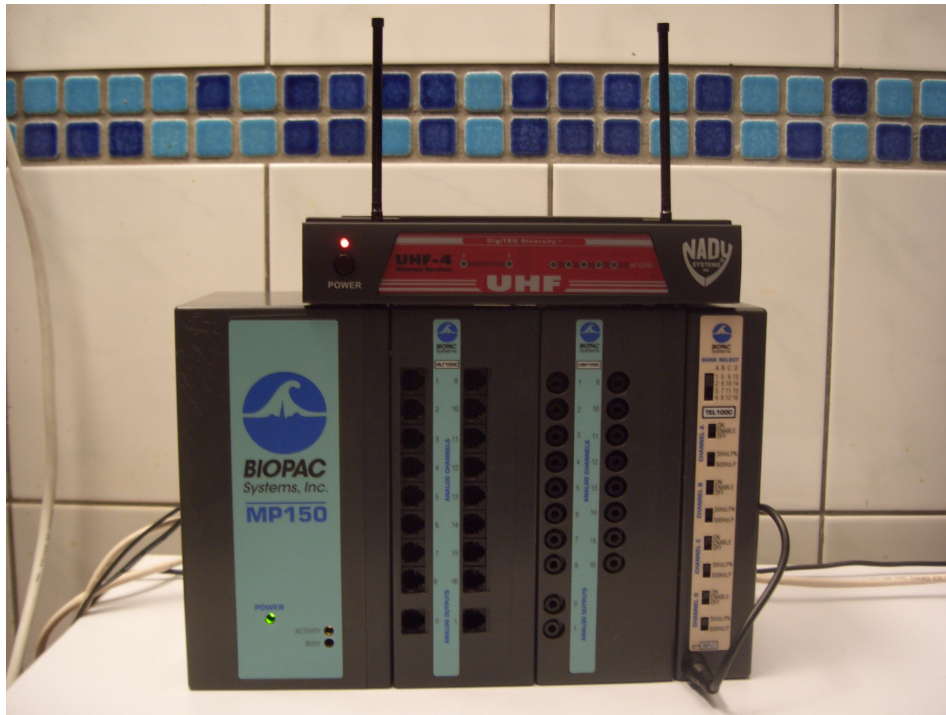
圖 14 電波接受器 TEL 100R(上)與解調器 TEL 100D-RF(下)
