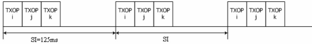
圖 2-5：HC 在共同服務區間(SI)內，依序對各個 STA 提供 Polled TXOP。
