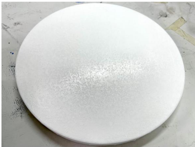
【圖 53】以點搓的方式打底，打磨後仍會保留細微的凹突肌理變化。
