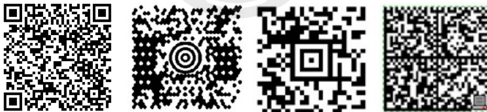
圖 2-1-3 矩陣式二維條碼，由左到右分別為 QR code、Maxi Code、Aztec code、Data Matrix
